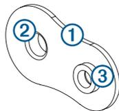
Se você estiver usando uma placa de retenção da porca, o orifício menor ③ na placa de retenção da porca deve alinhar com o orifício menor do modelo.
